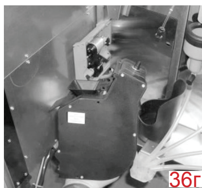
Рисунок 36 - Демонтаж группы эспresso
