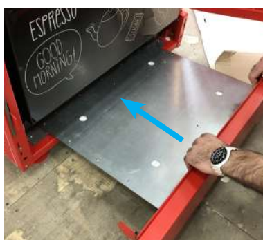
Рисунок А.16 - Установка поддона
