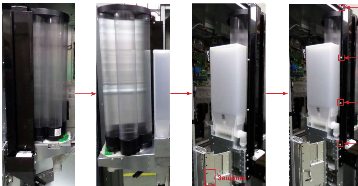
Рисунок 20 - Установка направляющей для размешивателей
