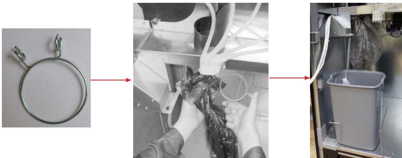
Рисунок 25 - Обжим мешка для сбора твёрдых отходов
