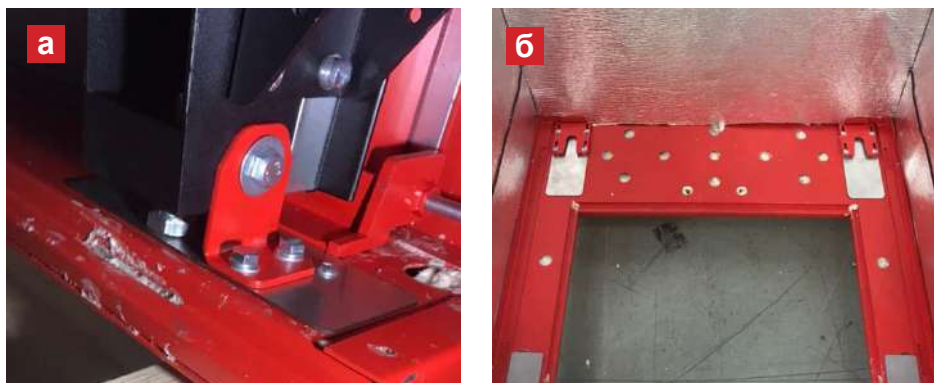
Рисунок А.5 - Снятие уголка и ловителей
