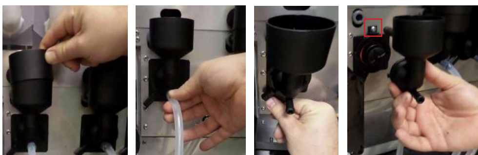
Рисунок 38 - Демонтаж миксера
