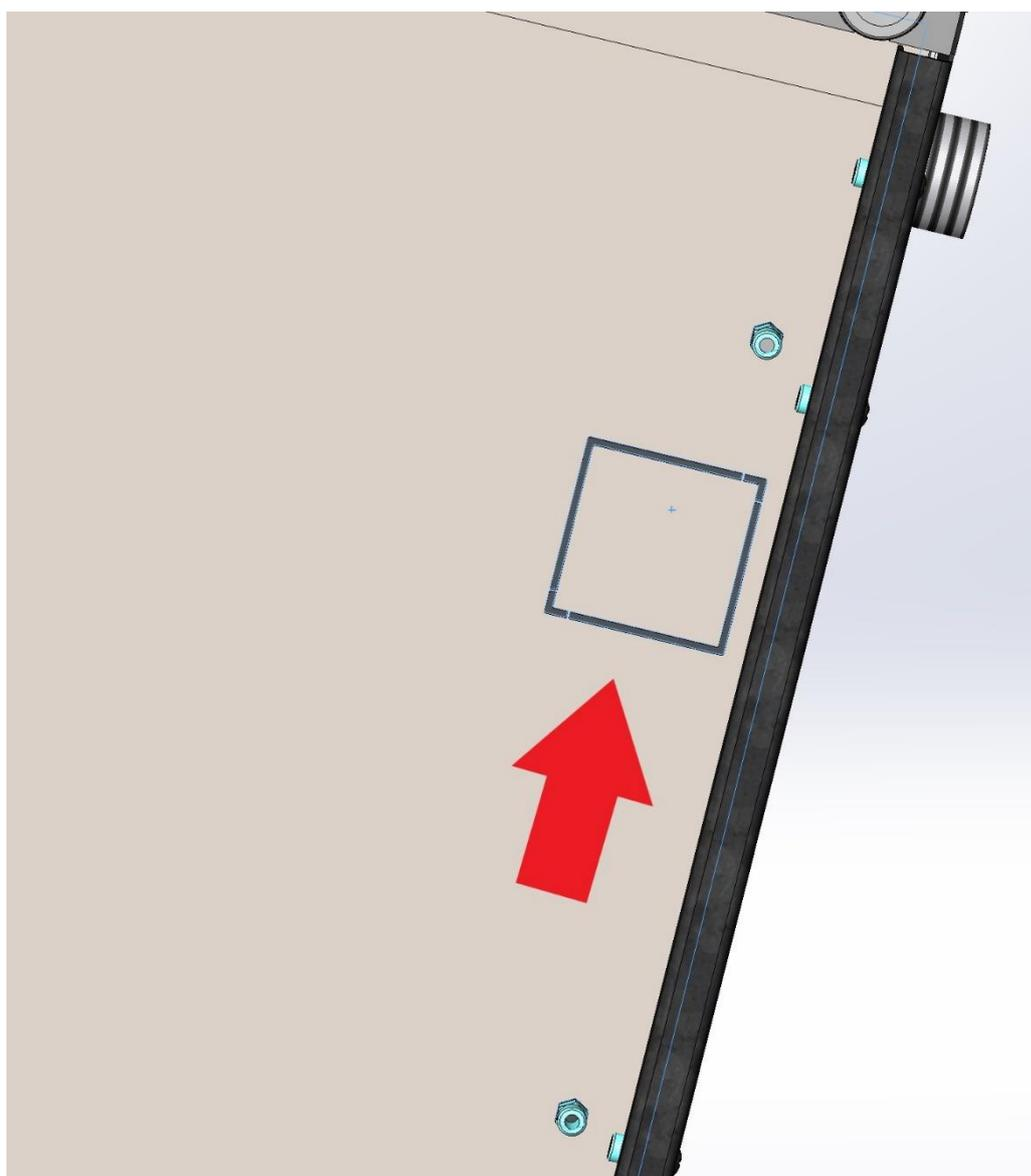
4. Через полученное отверстие в днище ТА протянуть кабель и шлейф от модуля выдачи стаканов.
