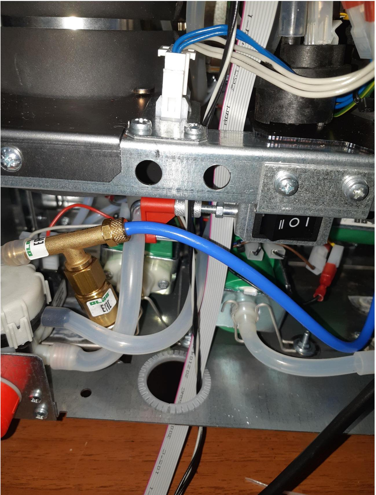
5. Чёрно-белый кабель протянуть вдоль имеющейся проводки и подвязать к ней при помощи стяжек. Двухконтактный соединитель кабеля необходимо подключить к соединителю J7 в правом верхнем углу платы управления. Свободный контакт на чёрном проводе необходимо вставить в контакт 12 соединителя J9 (через один ниже от красного провода).
