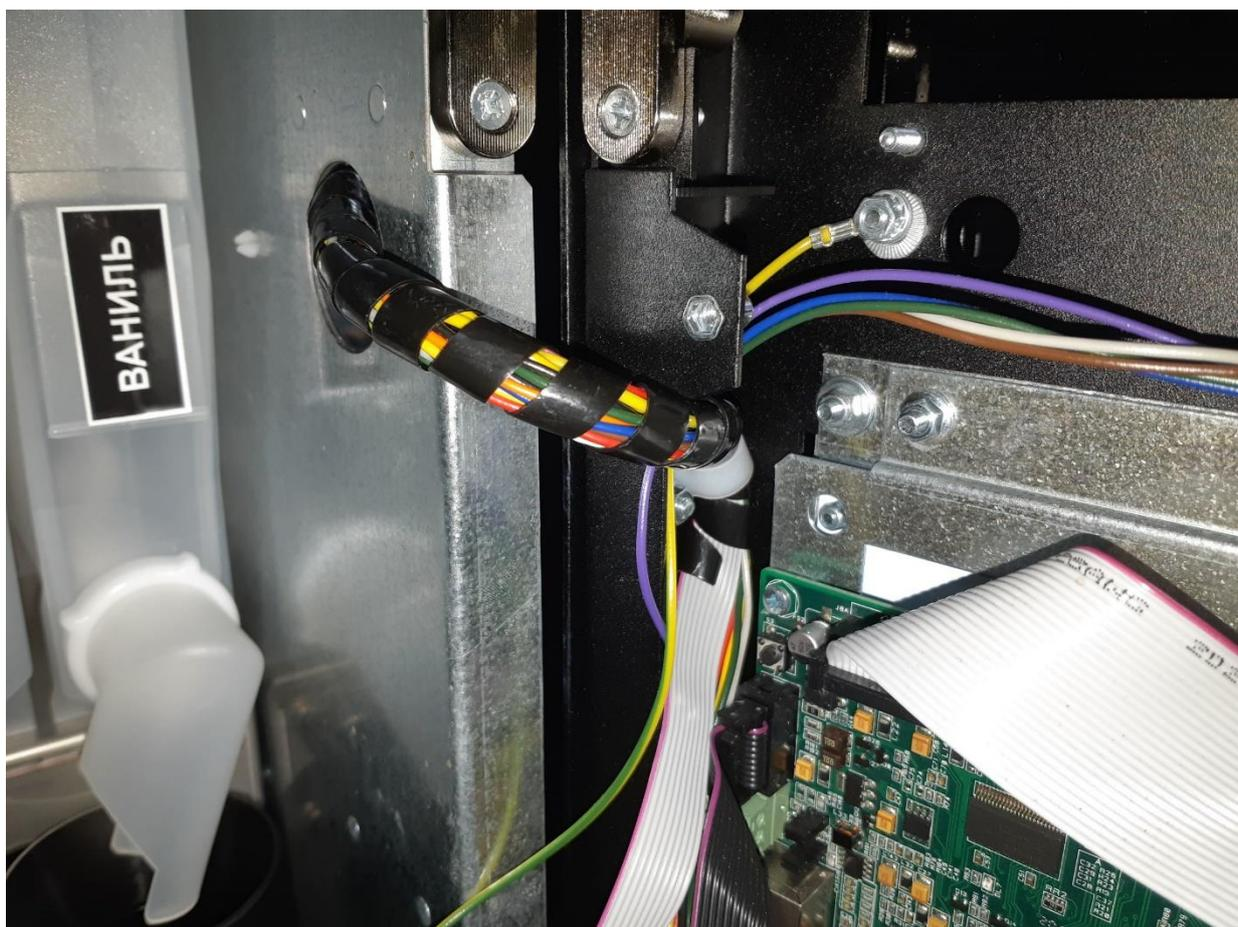
9. Подключить соединитель шлейфа к свободному соединителю X1 или X2 на плате сенсорной клавиатуры на двери ТА.
