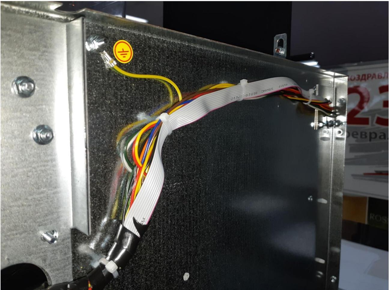
8. Размотать спиральную ленту, защищающую жгут в месте его перехода на дверь. Протянуть шлейф вместе со жгутом и замотать спиральной лентой.
